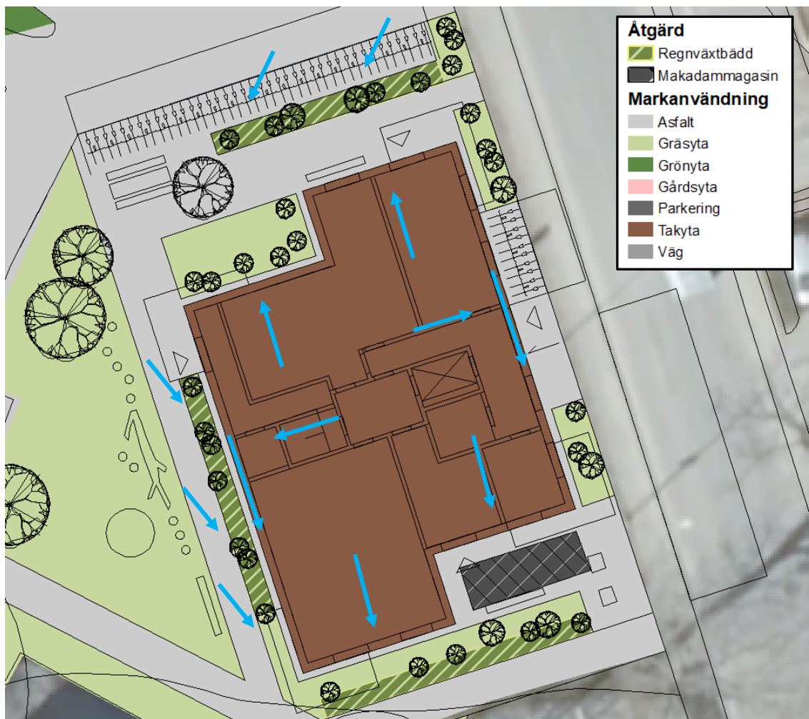
Figur 25. Dagvattenhantering kring hus 4, Brickan 2. Föreslagen flödesriktning redovisas med blåa rinnpilar.
