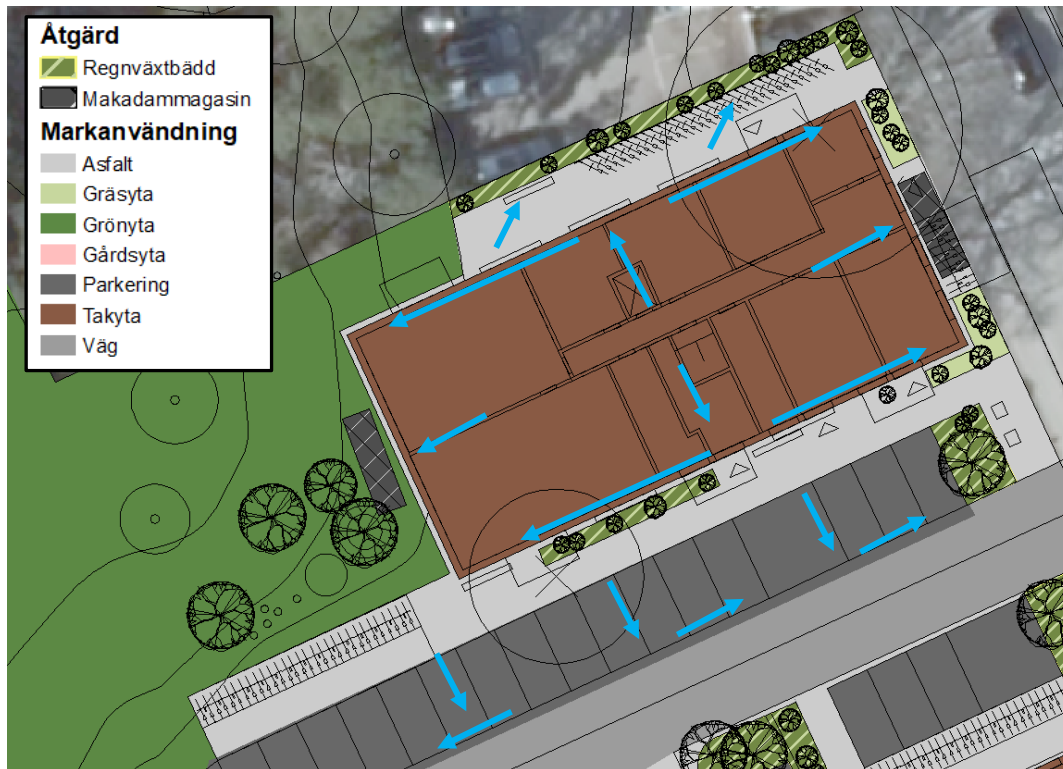
Figur 27. Dagvattenhantering kring hus 2, Brickan 6. Förslag på flödesriktning redovisas med blåa rinnpilar.
